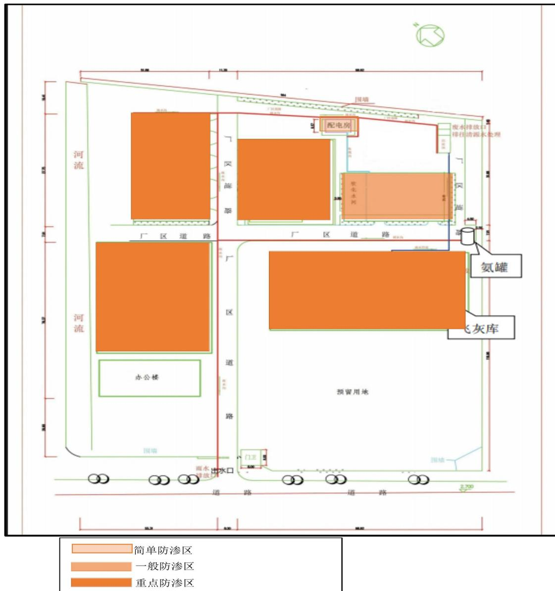
图 6.5-1 项目厂区地下水污染防治分区防渗示意图
