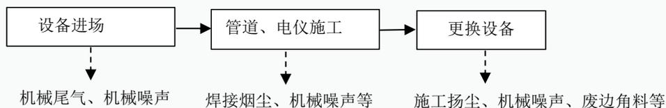
图 2-1 施工期工艺流程及产污环节示意图
